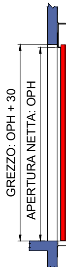
SEZIONE TELAIIO PORTE NF (EI120)
