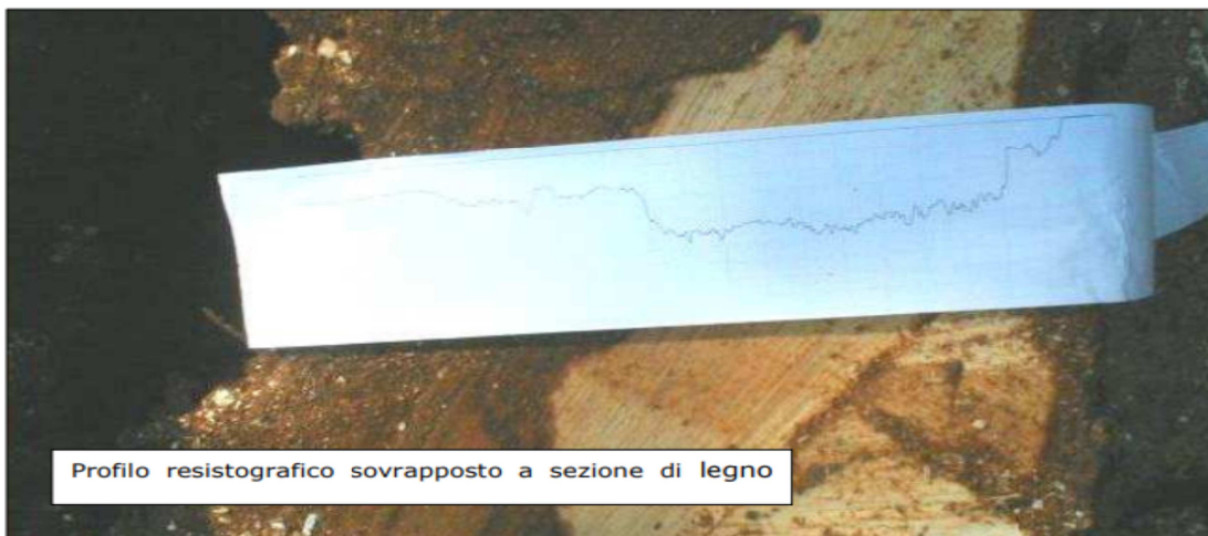
Figura 2 Profilo resistografico sovrapposto a sezione di legno.
