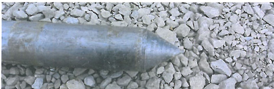
Particolare punta Campionatore nella posizione di infissione a pressione
