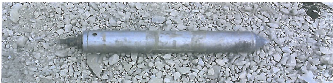
Campionatore nella posizione di infissione a pressione
