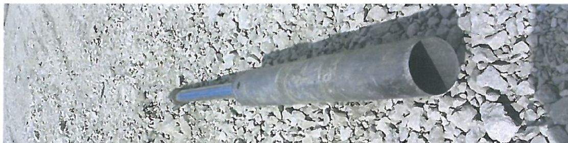
Particolare fustella Campionatore nella posizione di prelievo a pressione
