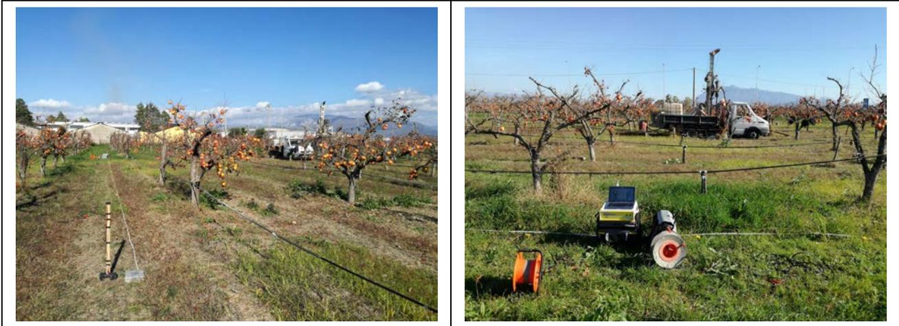
Foto dell'indagine sismica MASW
