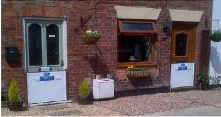
*Figura 43 – Paratoie manuali a protezione di porte di ingresso*
