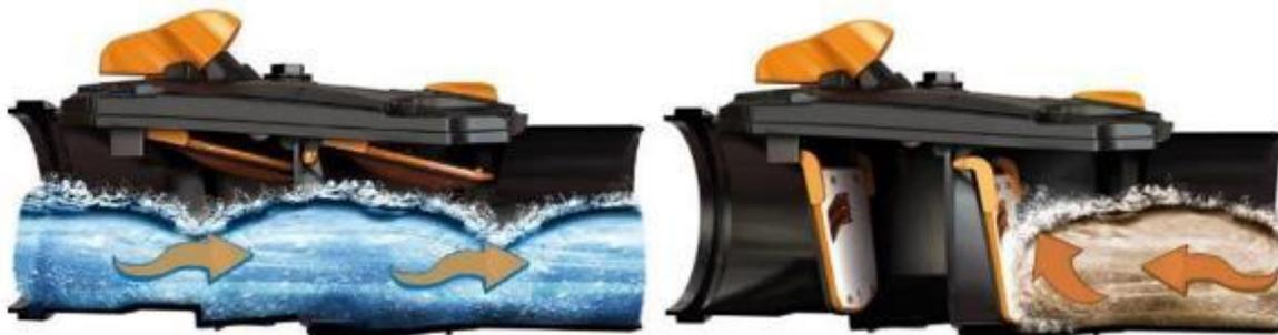
*Figura 44 – Funzionamento del sistema antiriflusso*
