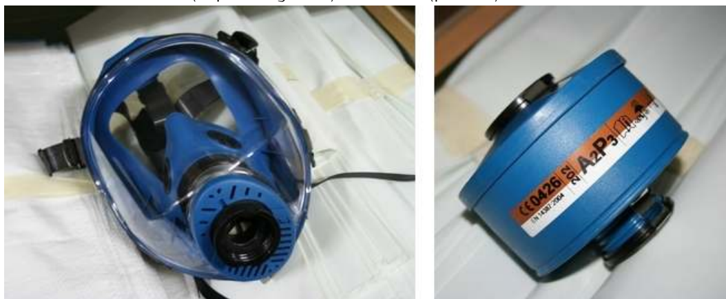
Figura 6.3: Maschera facciale completa e relativo filtro da montare, colore marrone (vapori organici) e bianco (polveri).
