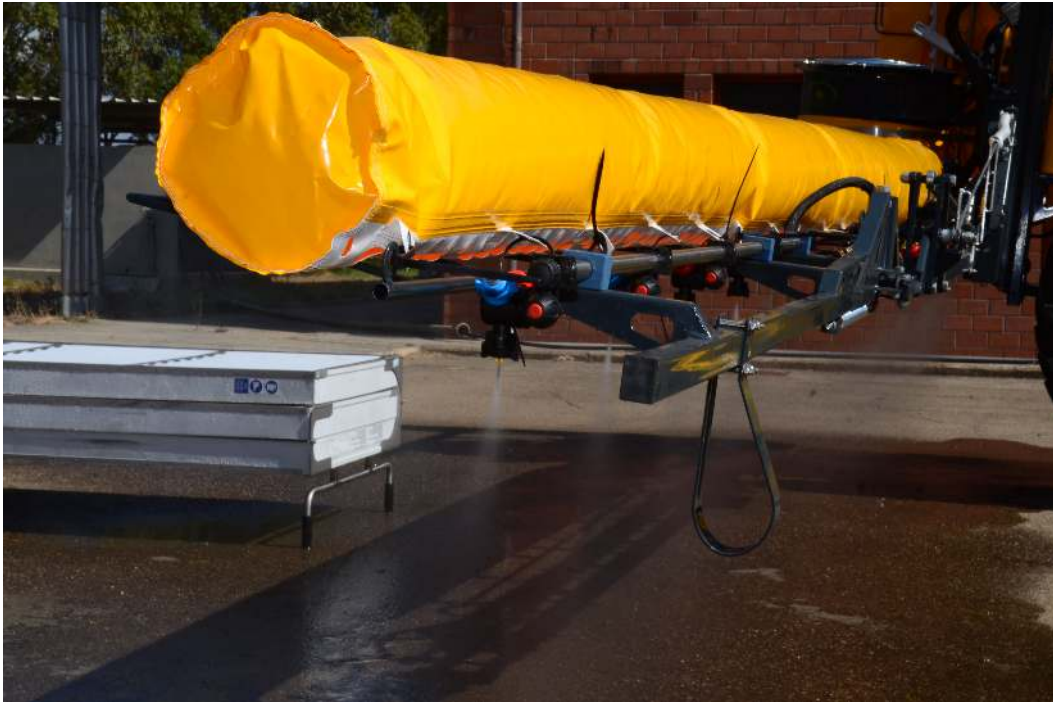
Figura 9.1: Irroratrice a manica d'aria
