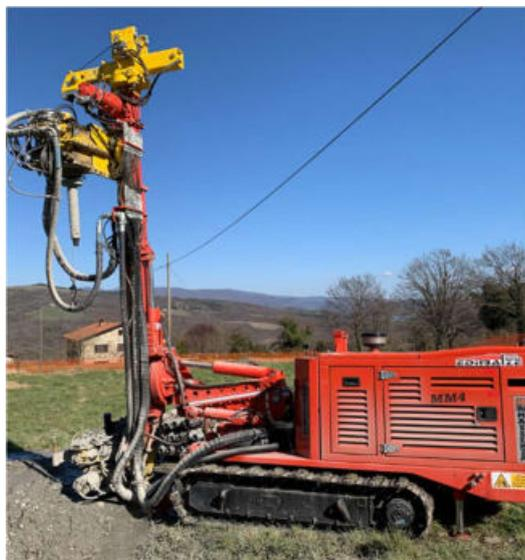
Figura 22 – Sonda – Perforazione poi attrezzata per prova sismica DH
