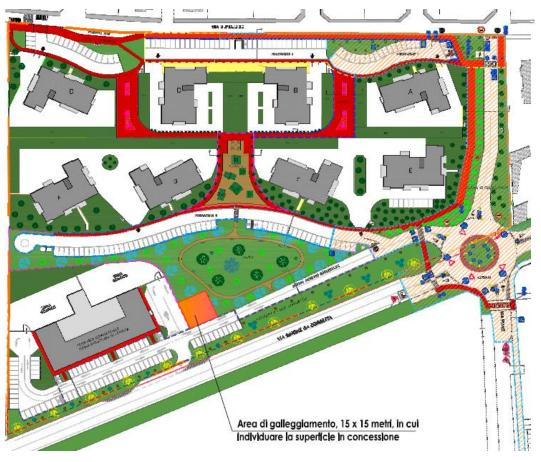
L'area compresa nel comparto di trasformazione urbanistica programma integrato di intervento AT5A. L'accessibilità veicolare avviene tramite una strada di arroccamento che si innesta sulla nuova rotatoria sulla strada ex statale.
