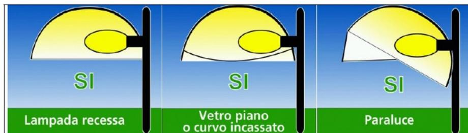
Fig.2 – Apparati conformi alla L.r. 17/09.
