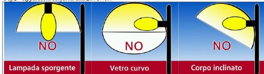
Fig.3 – Apparati che per configurazione non sono conformi alla L.r. 17/09.
