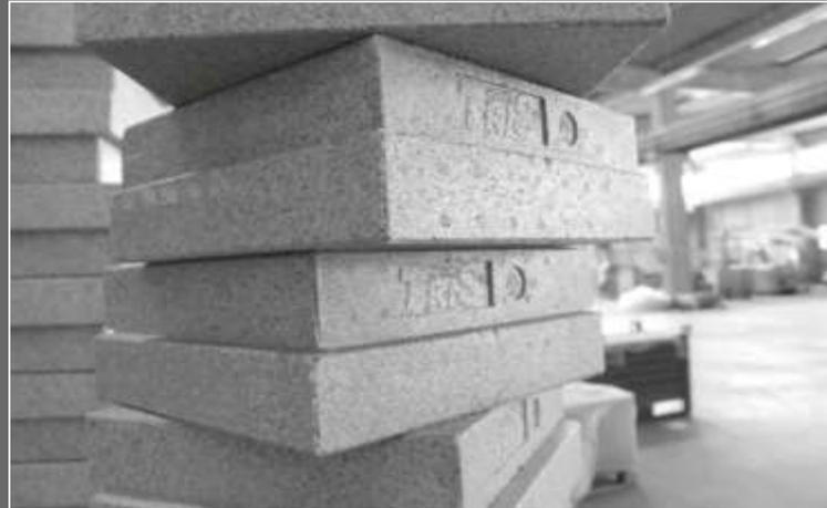
I pannelli isolanti in Neopor® sono resistenti all'invecchiamento e al deterioramento, e mostrano un'elevatissima stabilità del materiale e dimensionale.
