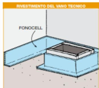
**RIVESTIMENTO DEGLI IMPIANTI NEL PASSAGGIO ATTRAVERSO I SOLAI**
