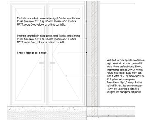
Sezione di dettaglio del rivestimento di facciata
