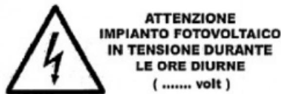
Poiché il generatore fotovoltaico è installato sulla copertura, detta segnaletica sarà installata in corrispondenza di tutti i varchi di accesso del fabbricato.
