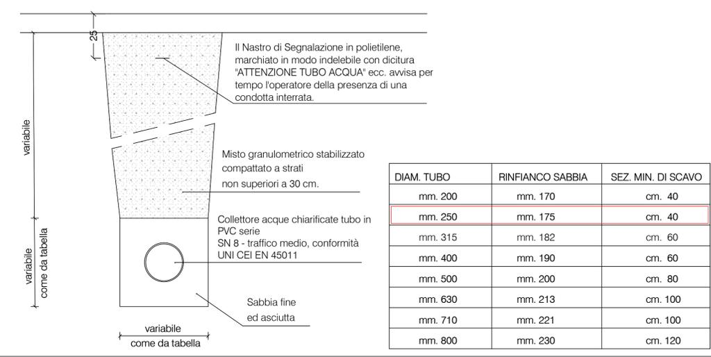
**PARTICOLARE SEZIONE SCAVO - Rete idrica**
