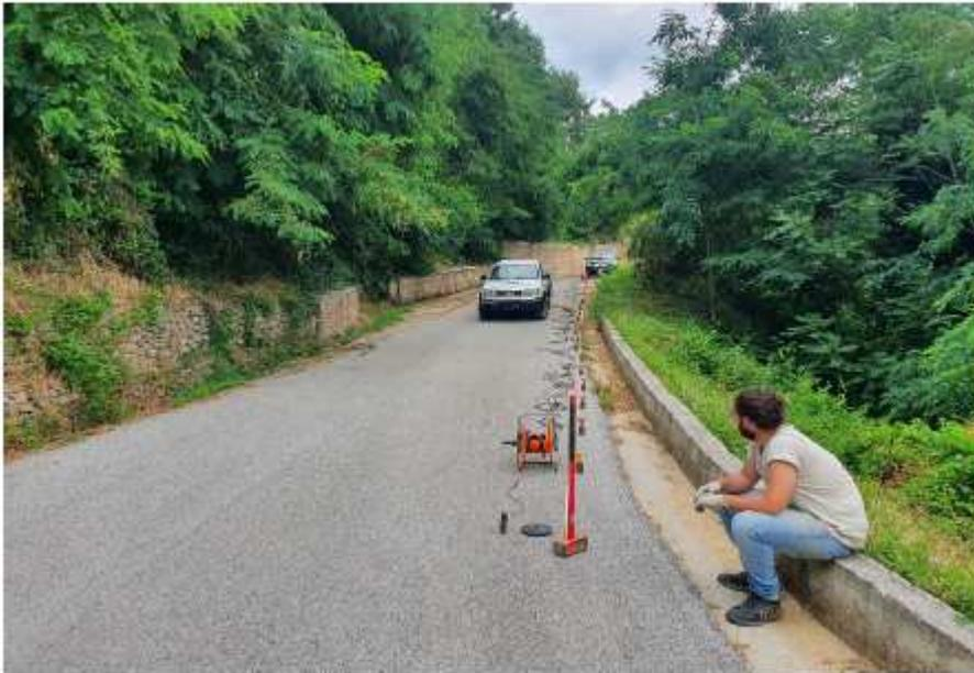
L'elaborazione della prova MASW ha permesso l'individuazione dei diversi sismostrati all'interno dei primi 30 metri di profondità dal p.c., caratterizzati da diverse velocità delle onde sismiche di taglio  $V_s$ , determinando una velocità media  $V_{s_{eq}}$  di 372 m/s dal p.c. fino a 14,40 mt dove è stato intercettato il bedrock sismico > 800 m/s.
