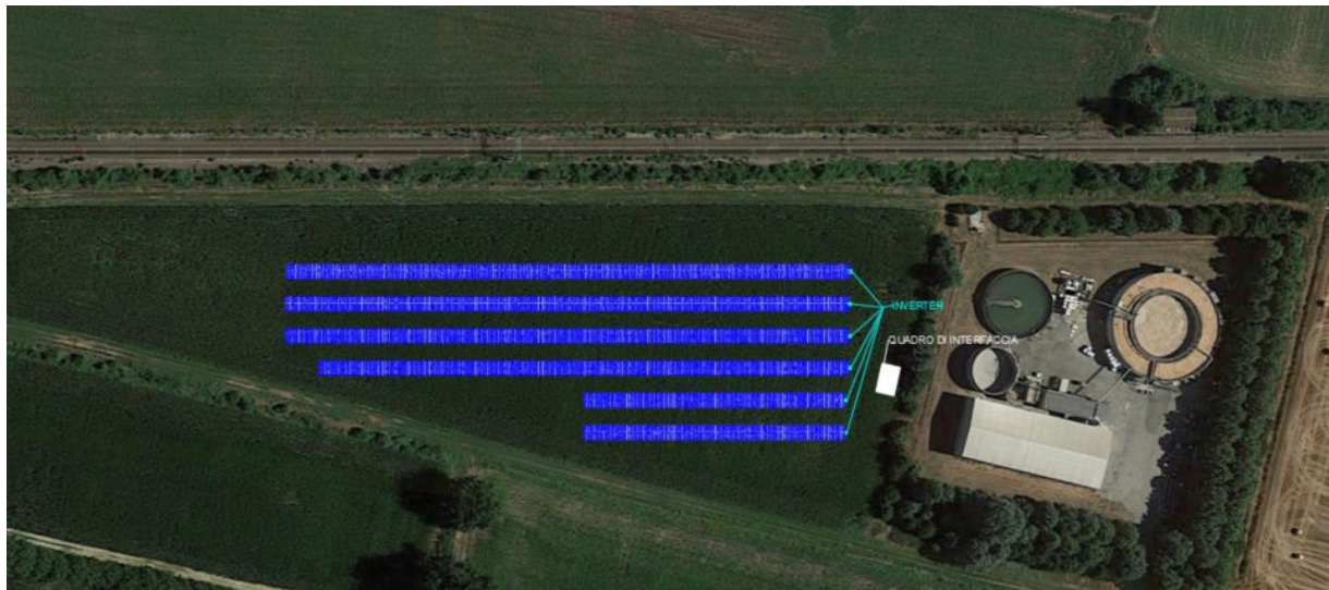
Figura 10: Posizione Inverter e quadro di interfaccia
