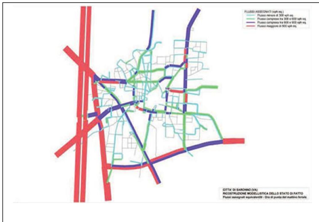
**Flussi veicolari- Ricostruzione modellistica dello stato di fatto, ora di punta del mattino –**
