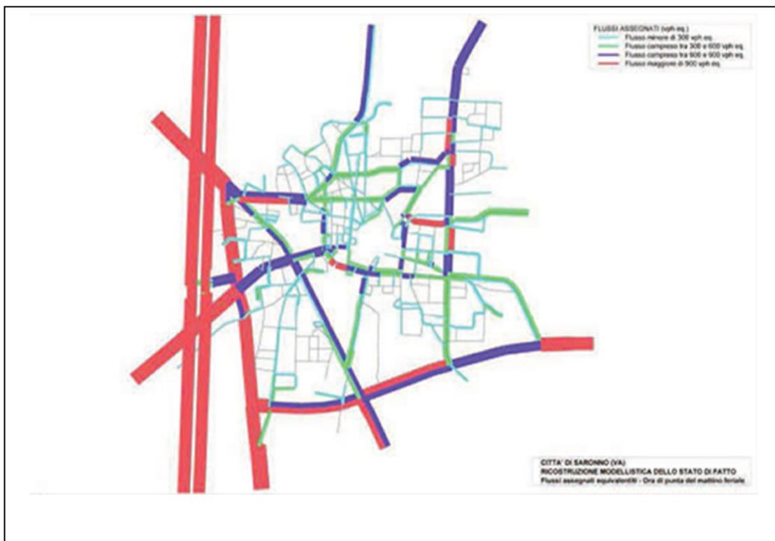
**Flussi veicolari- Ricostruzione modellistica dello stato di fatto, ora di punta del mattino – (fonte:Documento di Scoping-Piano Urbano del Traffico tab.5.14)**
