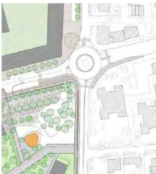
Figura 71 – Intervento viabilistico: nuova rotondella via Miola / via Mazzolari e spartitraffico via Miola / via S. Dalmazio
