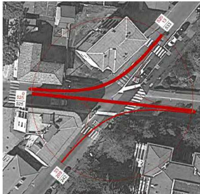
Figura 55 – Intersezione 1 – matrice flussi – Ora di punta
