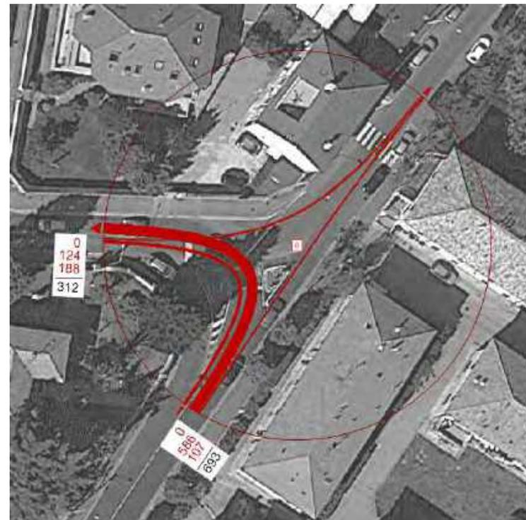
Figura 63 – Intersezione 9 – matrice flussi – Ora di punta
