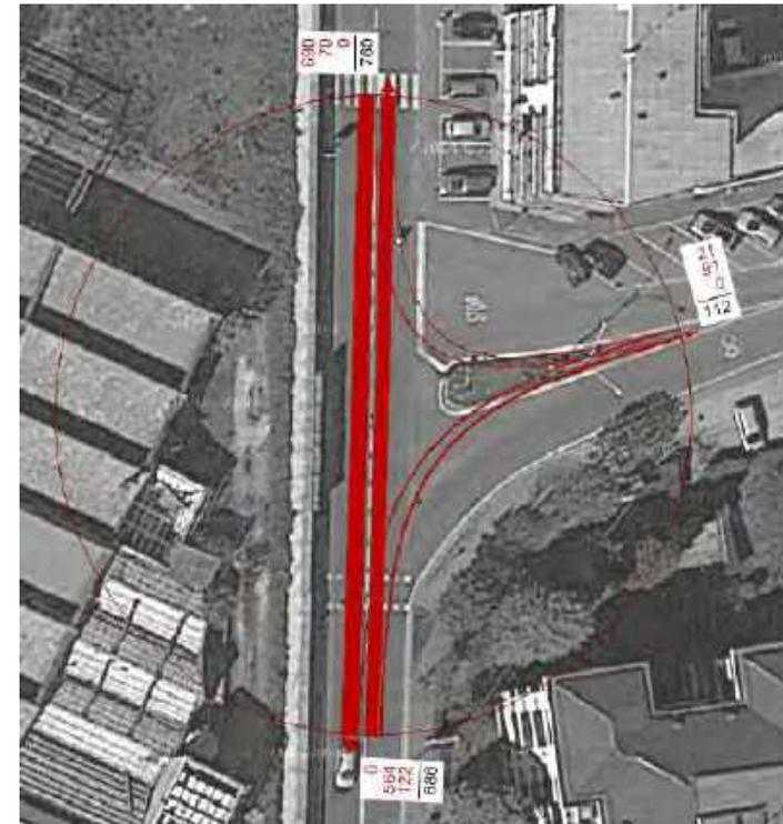
Figura 57 – Intersezione 3 – matrice flussi – Ora di punta
