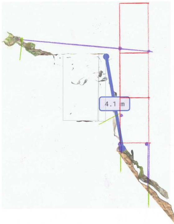
Figura 1.6 – Sezione tipo con ponteggio di tipo A
