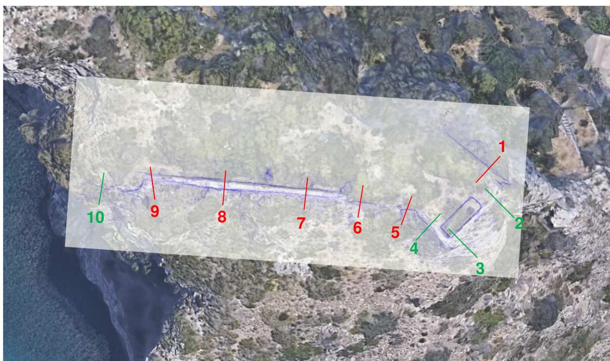
**Fig. 15: Sezioni di intervento con indicato in colore verde le sezioni con roccia sub-affiorante ed in colore rosso quelle con materiale sciolto soprastante**
