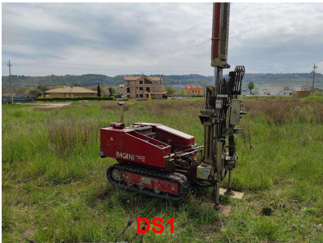
Foto 2: Penetrometrica superpesante effettuata con Pagani 63/200.
