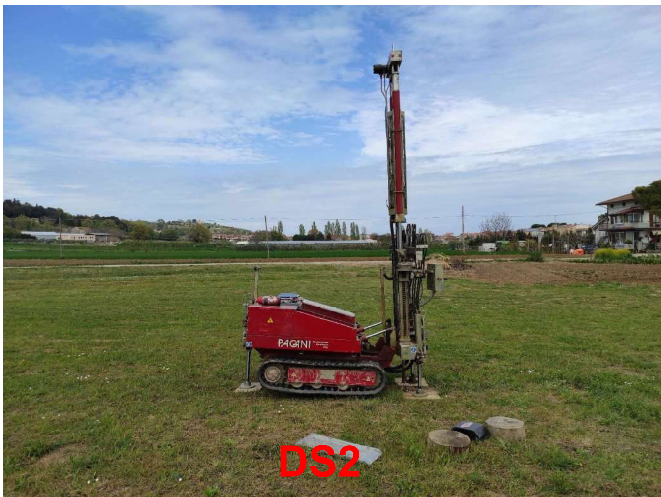
Figura 4: Indagine penetrometrica P2.
