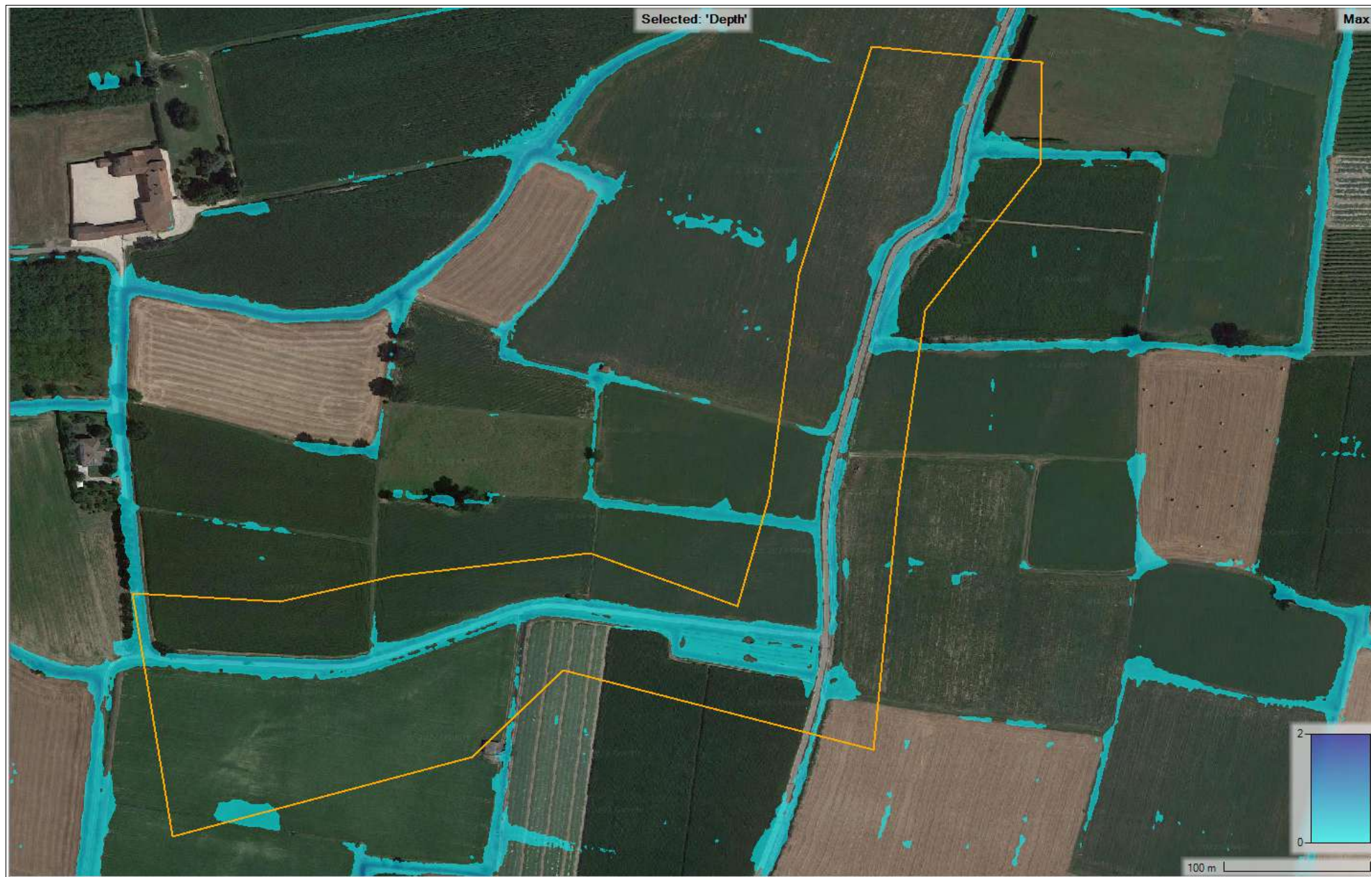
Fig. 104 - Planimetria criticità idrauliche per evento con tempo di ritorno 10 anni e durata 3 ore – Canale Scurtabaffa – Zona Via Pangona a sud del civico 76
