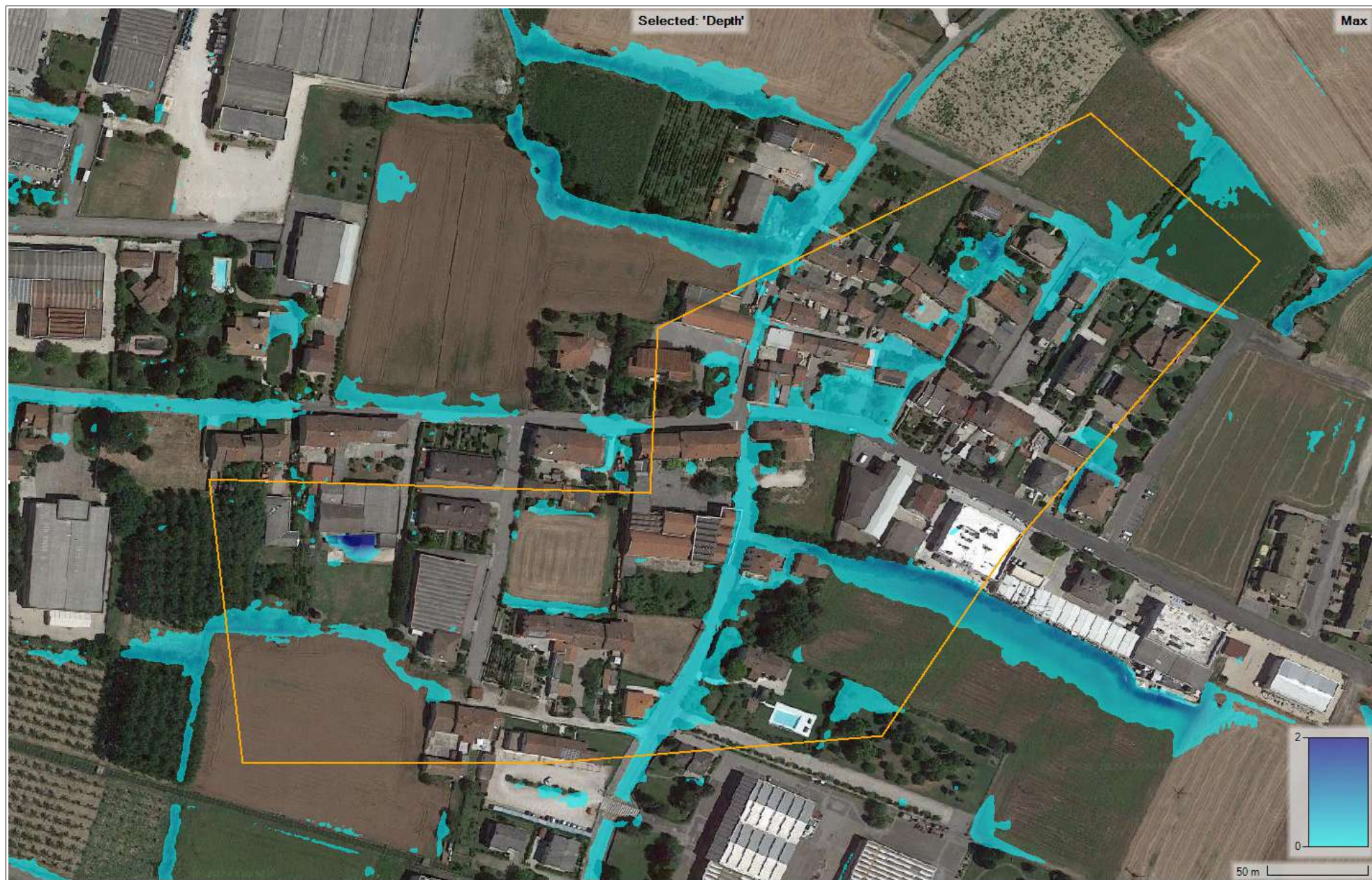
Fig.103 - Planimetria criticità idrauliche per evento con tempo di ritorno 10 anni e durata 3 ore – Canale Cicognara – Zona Via Codebruni Levante
