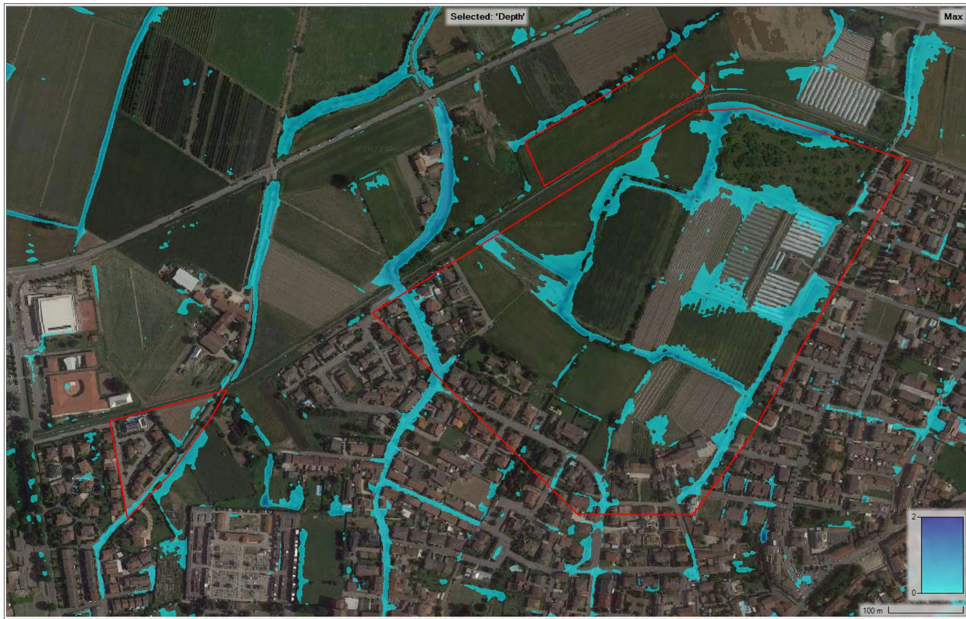
Fig. 107 - Planimetria criticità idrauliche per evento con tempo di ritorno 10 anni e durata 3 ore – Via Cagnola e area San Pietro
