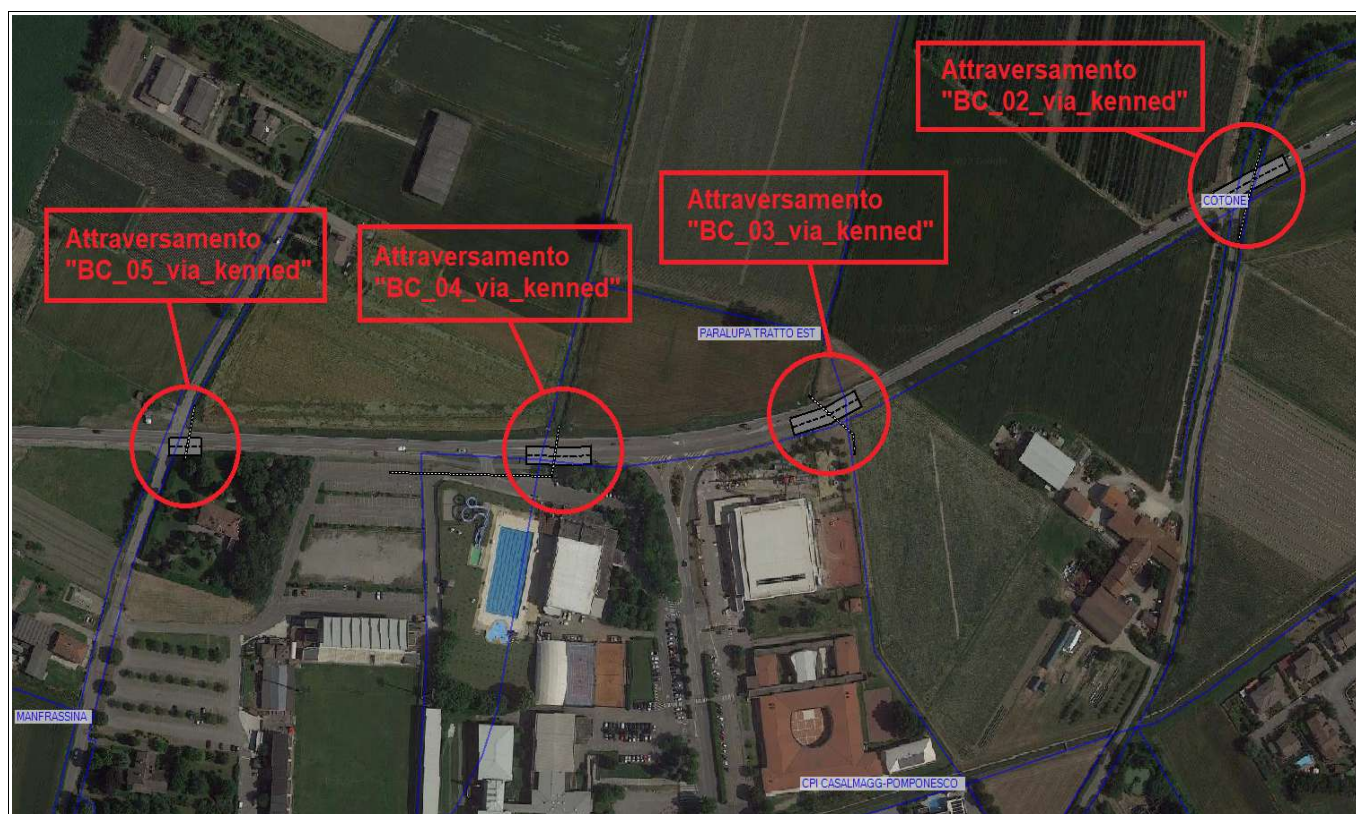
Fig. 59 - Stralcio planimetrico del dominio di calcolo con individuazione di alcuni attraversamenti inseriti nel modello come "Connections"
