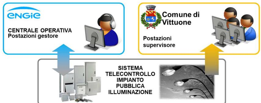
**Giornalmente**, durante il normale orario di lavoro, il Responsabile di Servizio o la Centrale Operativa procederanno **all'interrogazione telematica delle apparecchiature per la verifica del corretto funzionamento degli impianti con impostazione e regolazione dei parametri di funzionamento**.
