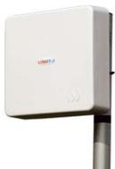
Apparato periferico Wireless per reti Lan Ethernet a 5,4GHz. Outdoor standard IEEE 802.11 f/fn/ac (Hiperlan2), configurabile Station o Bridge, campo di frequenza 5470÷5725MHz, modulazione OFDM, potenza 1W (EIRP @ 5GHz), antenna a pannello integrata (guadagno 20dBi), angolo di irradiazione H/V 15° @3dB, larghezza di banda canale 20÷40MHz, trasmissione criptata WEP 64, 128 bit, 11 canali non sovrapposti, compatibile con protocolli IPV4, UDP multicast, TCP, ICMP, Telnet, http, FTP, SNMP,
