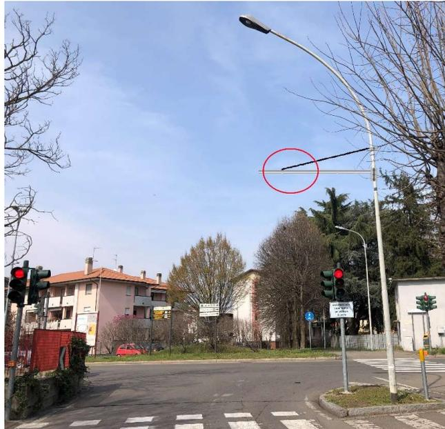
Allo scopo saranno posate **2 telecamere specifiche, di cui una OCR di lettura targhe ed una seconda di contesto**, entrambe con risoluzione d'immagine 2Mpx, abbinate nativamente "in campo" per immagini perfettamente sincronizzate. Per l'integrazione della telecamera OCR sarà prevista una nuova licenza canale del software Traffic Scanner, con Plug-In per collegamento al database MCTC.
