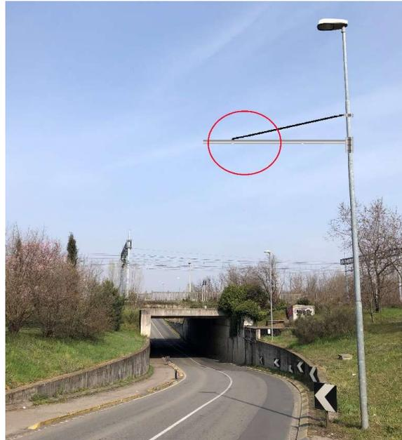
Allo scopo saranno posate **2 telecamere specifiche, di cui una OCR di lettura targhe ed una seconda di contesto**, entrambe con risoluzione d'immagine 2Mpx, abbinate nativamente "in campo" per immagini perfettamente sincronizzate. Per l'integrazione della telecamera OCR sarà prevista una nuova licenza canale del software Traffic Scanner, con Plug-In per collegamento al database MCTC.
