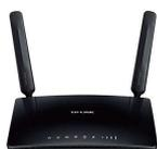
Router 4G LTE fino a 150 Mbps/Wireless N fino a 300Mbps, Porta LAN/WAN Permette di navigare senza linea fissa, in ambienti dove l'ADSL è assente, velocità 4G fino a 150Mbps in download e 50Mbps in upload, inoltre permette di connettere via Wi-Fi fino a 32 dispositivi, porta LAN / WAN liberamente configurabile per collegamento alternativo via cavo o modem a fibra ottica.
