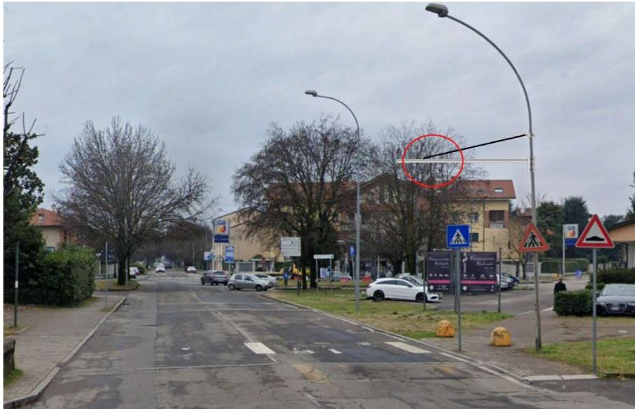
Allo scopo saranno posate **2 telecamere specifiche, di cui una OCR di lettura targhe ed una seconda di contesto**, entrambe con risoluzione d'immagine 2Mpx, abbinate nativamente "in campo" per immagini perfettamente sincronizzate. Per l'integrazione della telecamera OCR sarà prevista una nuova licenza canale del software Traffic Scanner, con Plug-In per collegamento al database MCTC.
