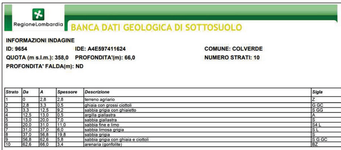
Fig. 3 – Stratigrafia pozzo idrico
