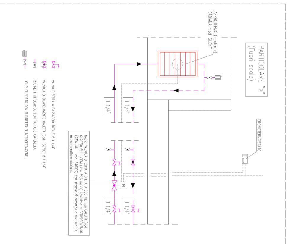
Nuova VALVOLA DI ZONA A SFERA A DUE VIE tipo CALEFFI (cod. 647070) Ø 1 1/4" (Kv= 39,6 mc/h) corredato di SERVOCOMANDO (230V AC - cod. 646002) con segnale di comando a due punti e microinterruttore ausiliario.
