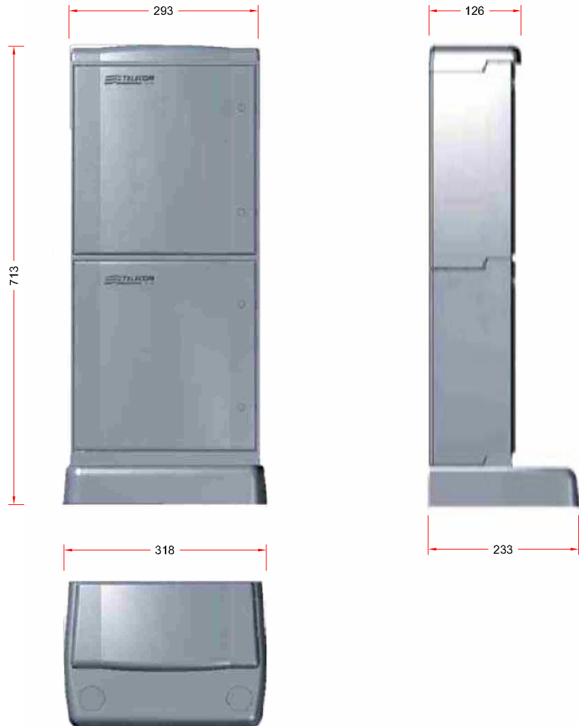
PARTICOLARE COLONNINA MODULARE IN PVC
