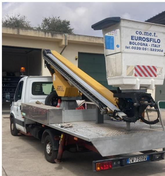
Trattasi di un tipo specifico di piattaforma aerea autocarrata denominato "autocestello", predisposto per lavorazioni in quota per lo spostamento di n. 2 persone tramite braccio telescopico.
