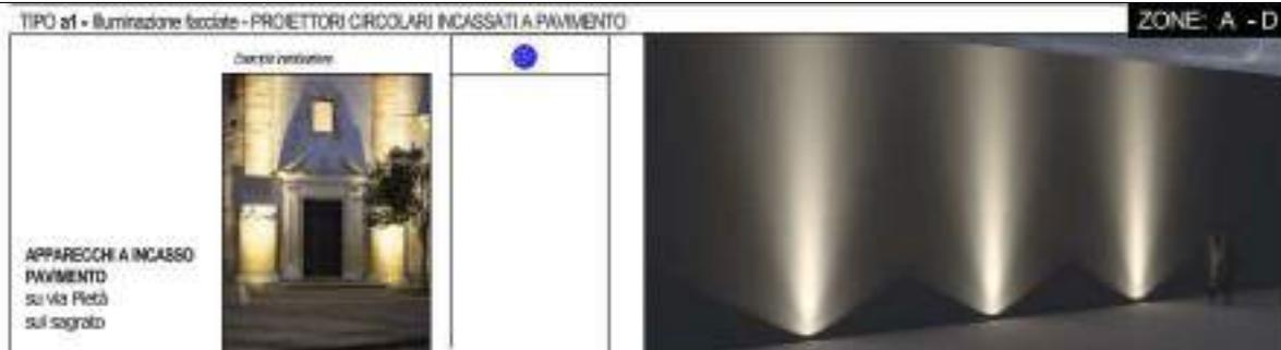
La scansione compositiva del prospetto principale comporta l'installazione di un doppio livello di diffusori: a quota sagrato saranno installati due proiettori (Rif. **a1**- tipo *NISO RECESSED XL RGBW di LLD*) a incasso pavimento che illumineranno un primo livello (dal basamento all'imposta del timpano) con fascio ottico 30°.
