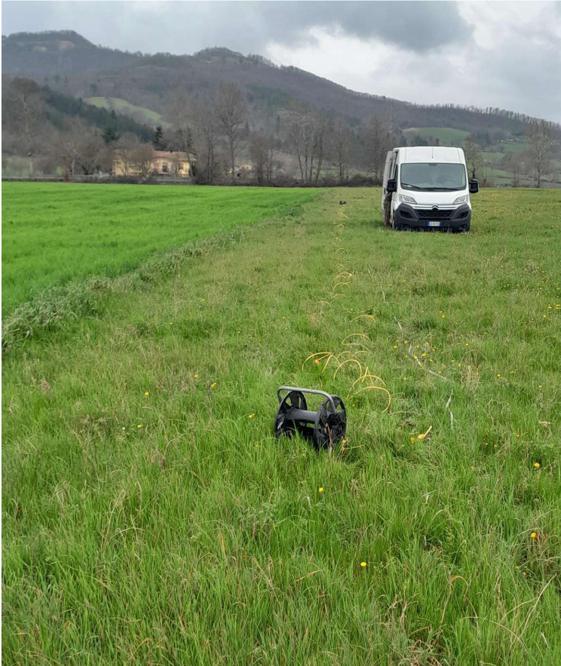
Foto 3.6 – Stendimento sismico MASW
