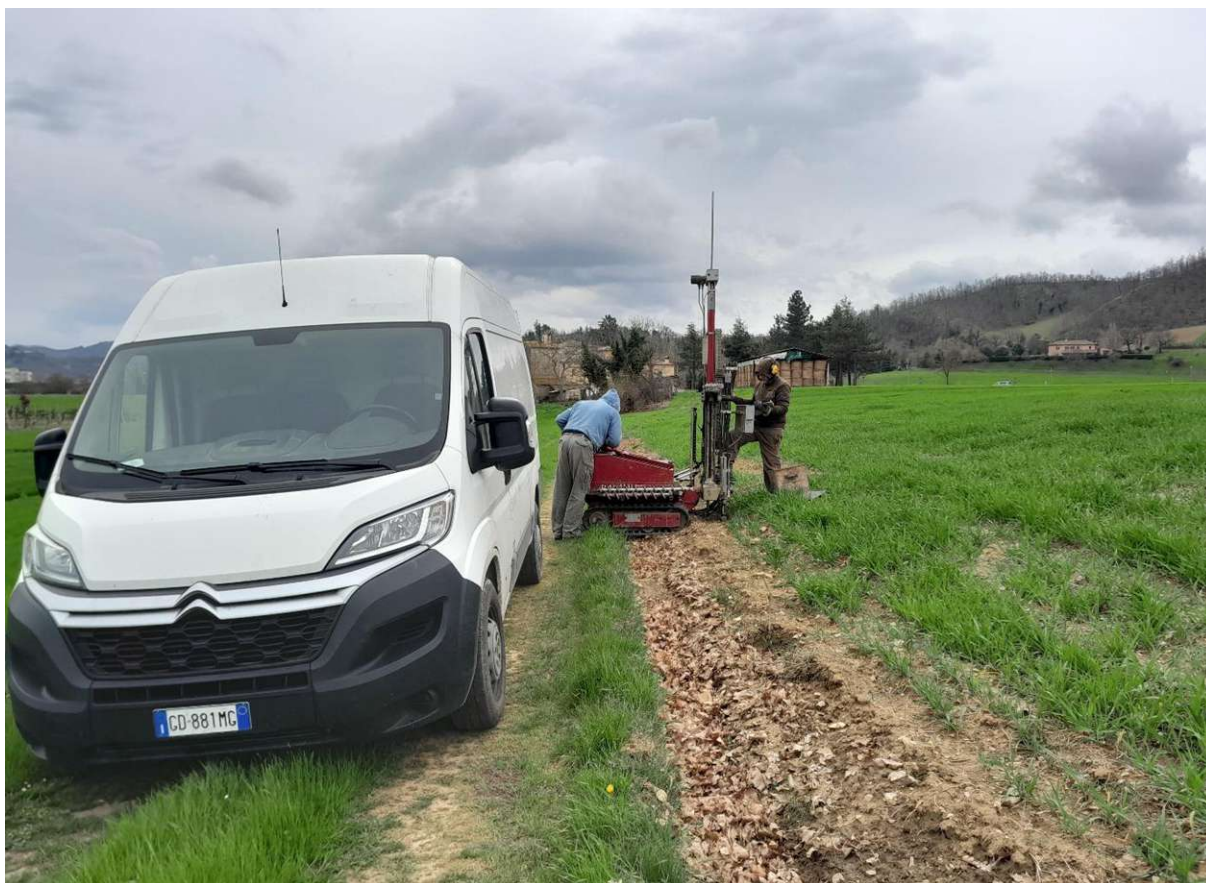
Foto 3.2 – Esecuzione prova penetrometrica DPSH3
