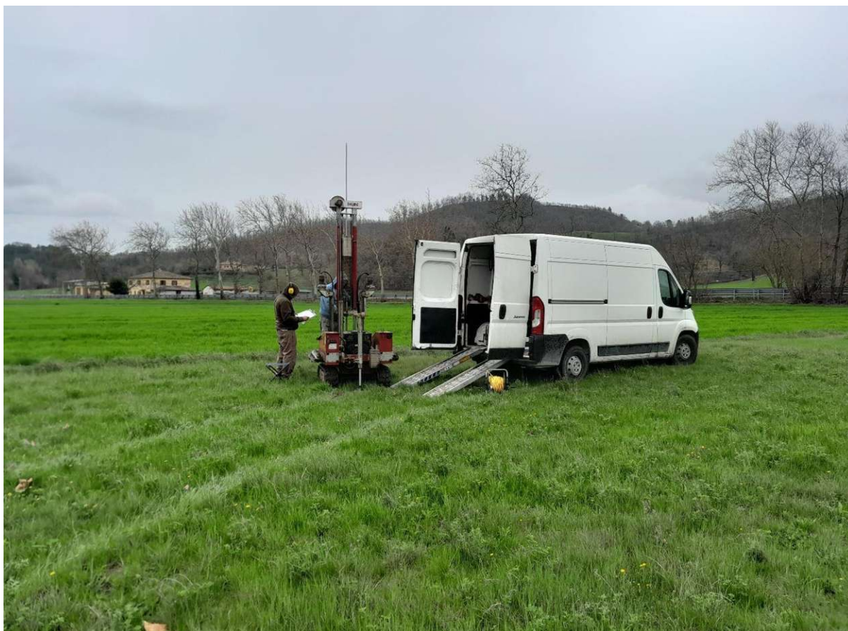
Foto 3.4 – Esecuzione prova penetrometrica DPSH7
