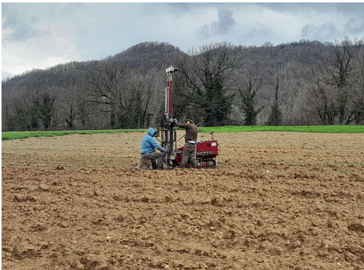
Foto 3.5 – Esecuzione prova penetrometrica DPSH10
