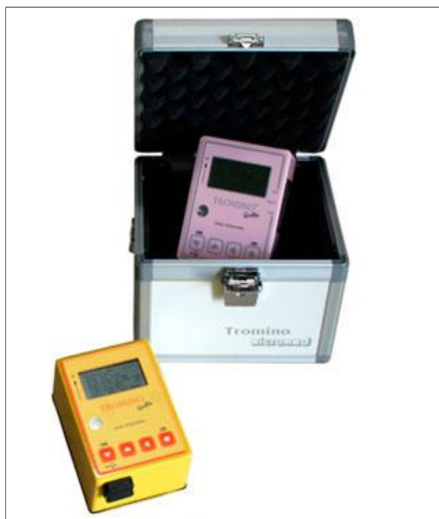
Figura 3.3 – Tromometro digitale utilizzato per la prova HVSR
