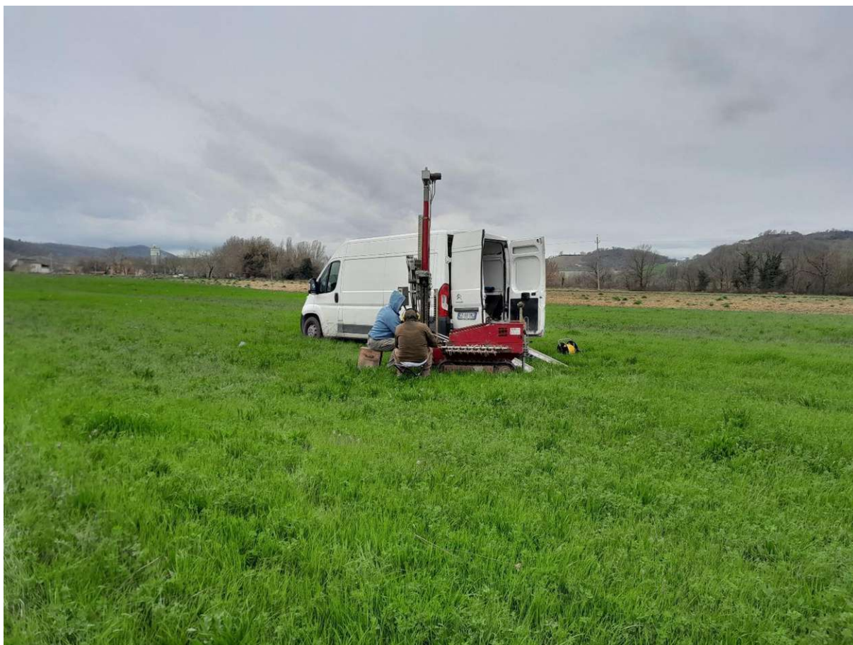
Foto 3.3 – Esecuzione prova penetrometrica DPSH5
