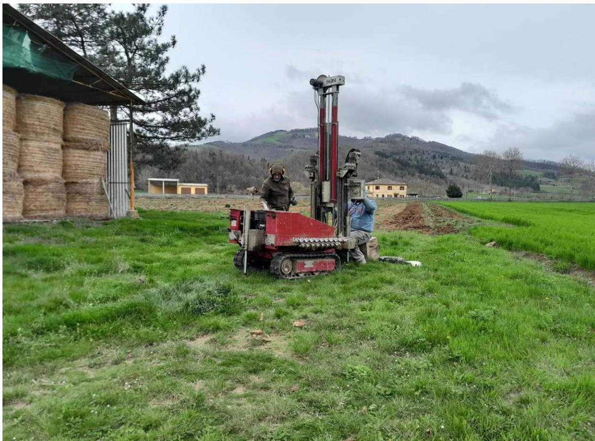
Foto 3.1 – Esecuzione prova penetrometrica DPSH1
