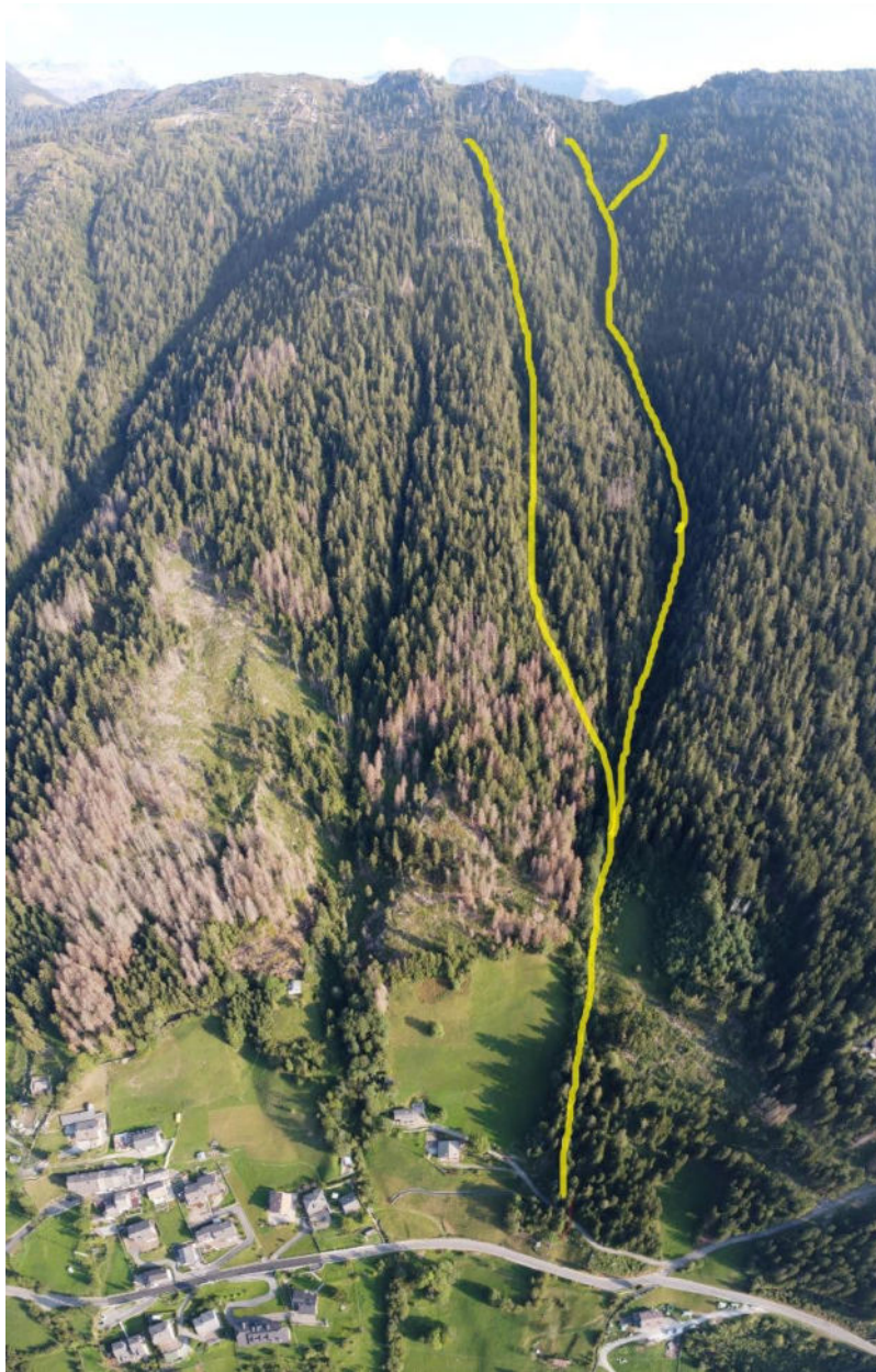
Figura 6 - Immagine da DRONE (Settembre 2021) con la potenziale “traccia” della valanga di interesse (giallo). Si individuano pertanto le zone di scorrimento e le aree di distacco distinte.
