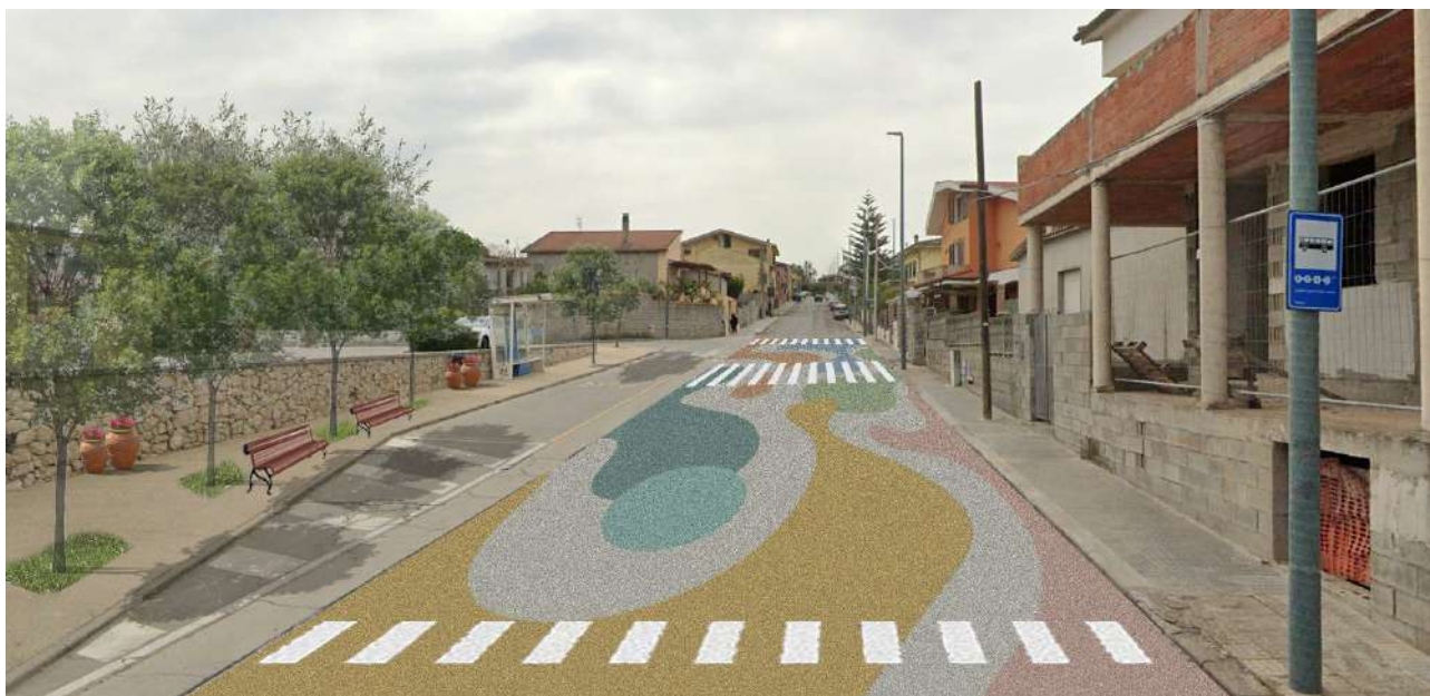
Realizzazione aiuole per alberature e stampa-colorazione asfalto tipo street-print
