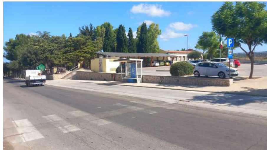
Fermata bus piazzale, assenza segnali podotattili e pedana rialzata
