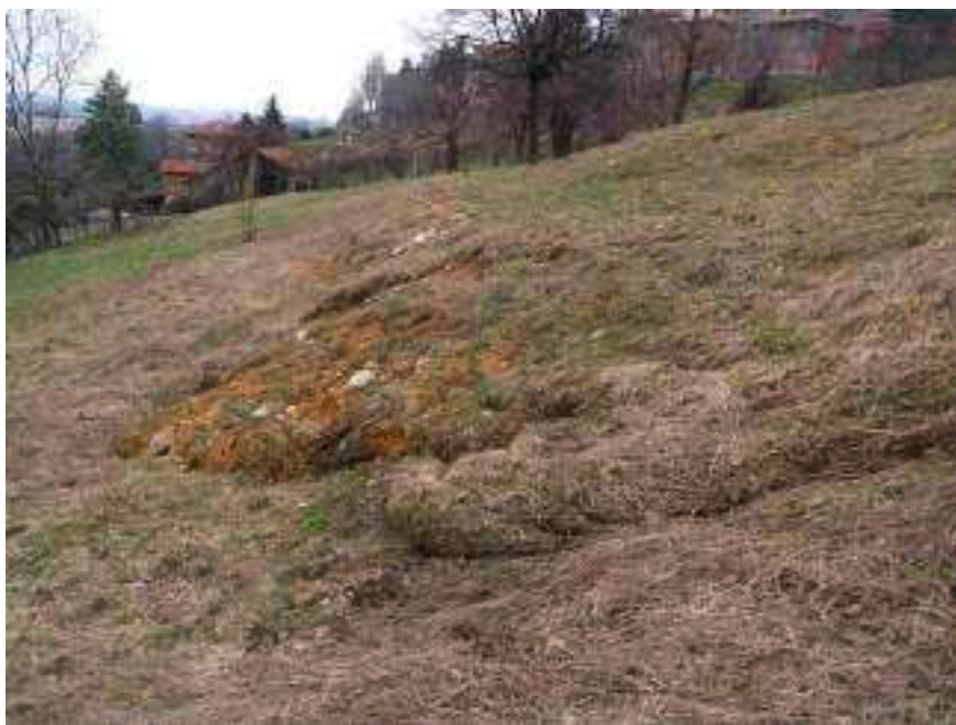
Immagine 09 - 2009_03_20-Riattivazione di marzo 2009, settore di accumulo
