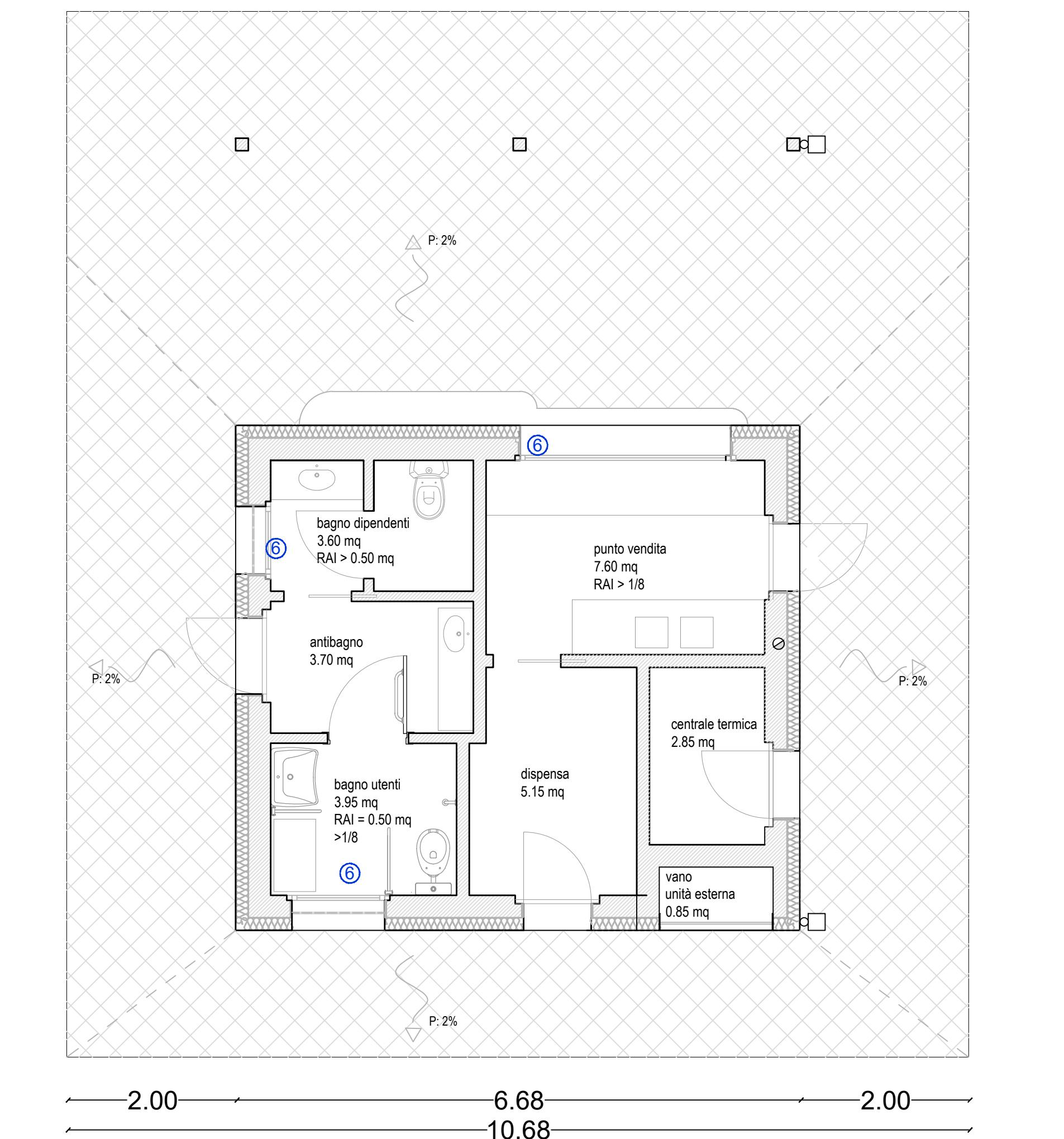
PIANTA PIANO COPERTURA E DISPOSITIVI ANTICADUTA
