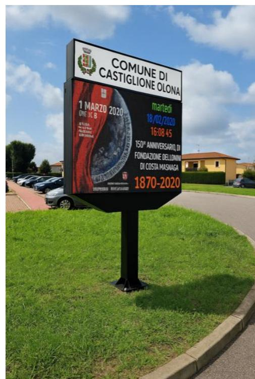
Caratteristiche principali : • Luminosità 6000 NIT • Pixel pitch: 3,91 mm • Area visibile LED: 2000 x 750 mm • Visibilità in distanza: da 2 a 80 metri • Angolo di visione 140° H - 140° V (+/-5°) • 4 aree grafiche – pixel pitch 4.81 • Livelli di grigio: 14 bit
