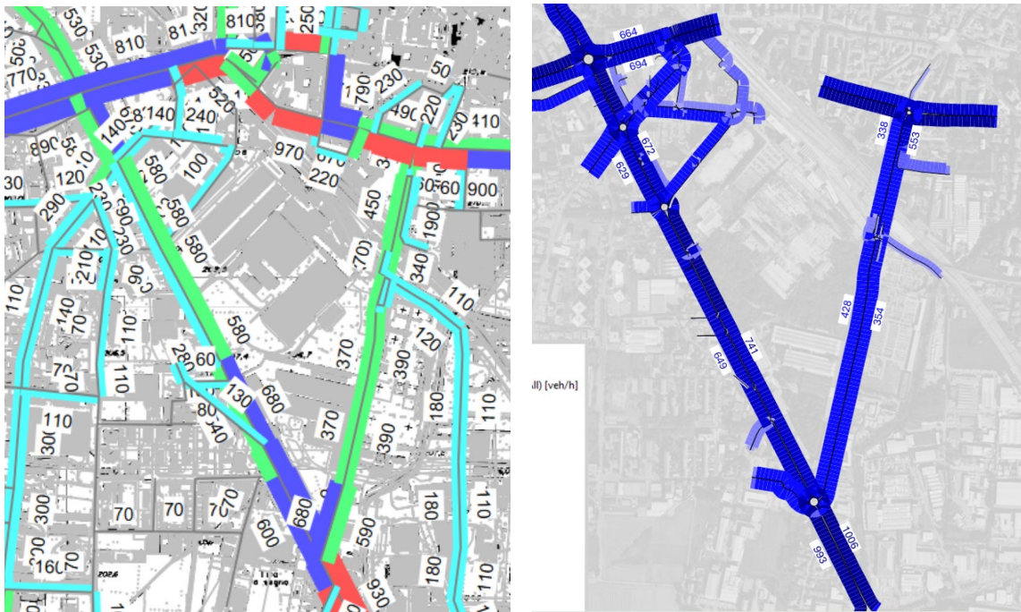
Figura 60 Comparazione flussogramma SDF PM vs. analogo modello del PGTU - Estratto PGTU Tav. 11: Modello di traffico stato di fatto
