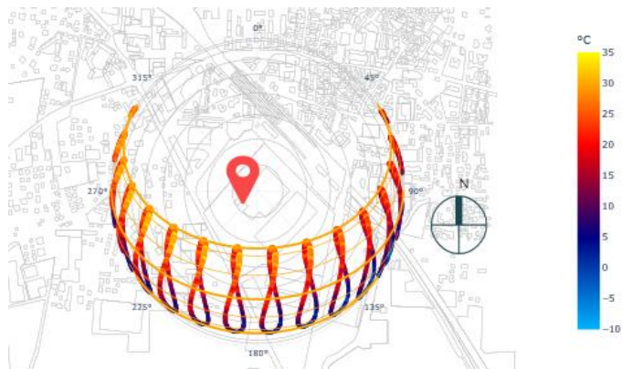
Percorso del sole sul sito di progetto durante l'intero anno, correlato alle temperature dell'aria esterna
