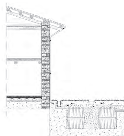
Schema di impianto di recupero dell'acqua piovana.
