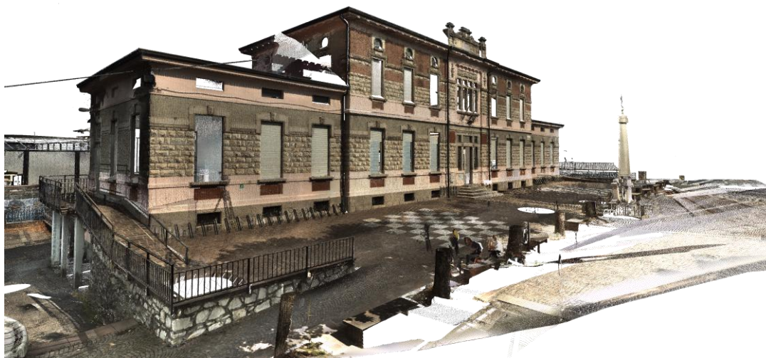
Restituzione rilievo Laser scanner come “nuvola di punti”
