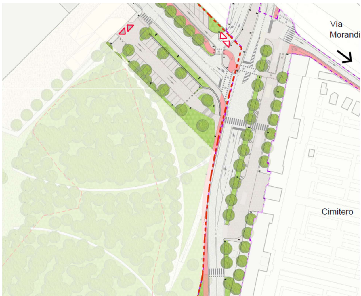
Soluzione intersezione semaforizzata (PII Adottato)
