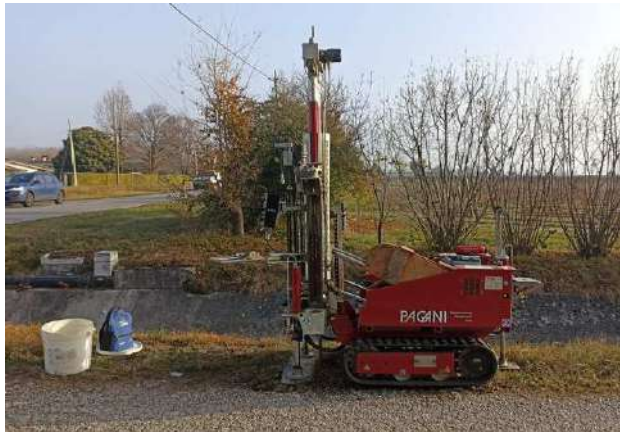
Esecuzione dell'indagine penetrometrica dinamica superpesante D.P.S.H.
