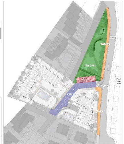
Planimetria Generale di progetto con individuazione aree standards da cedere Scala 1:500
