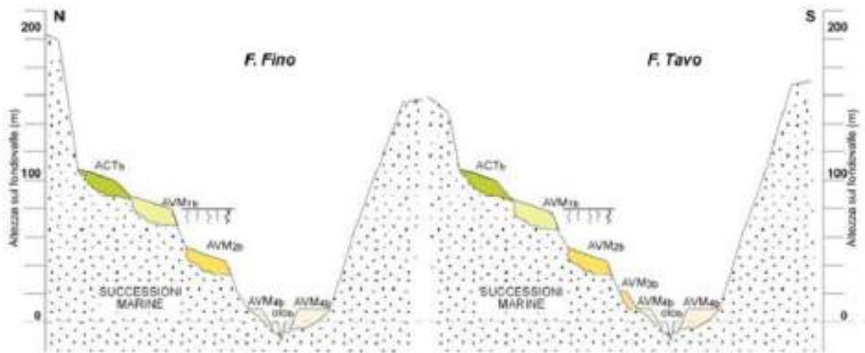
Figura 19 : Schema morfo-litostratigrafico delle unità distinte nei depositi post-orogenici del Quaternario continentale
