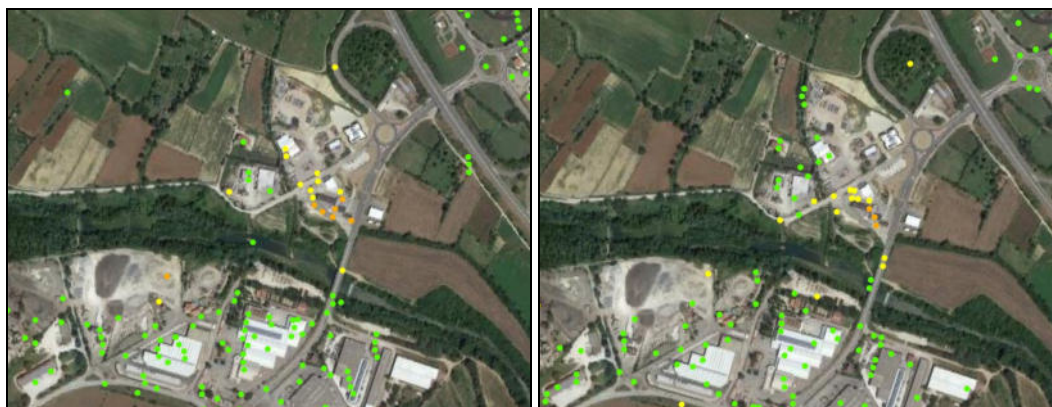
Distribuzione dei PS - Ascending (a sinistra) e Descending (a destra)- in un'area oggetto di interventi edilizi/movimenti di terra (San Sepolcro)
