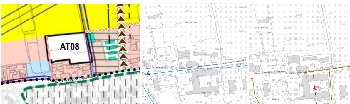
Estratto Relazione DP08 Carta delle Previsioni di Piano e relativo schema di rete idrica e fognaria
