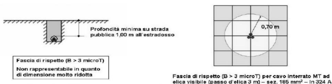
Figura 1: Curve di livello dell'induzione magnetica generata da cavi cordati ad elica – calcoli effettuati con il modello tridimensionale "Elico" della piattaforma "EMF Tools", che tiene conto del passo d'elica.
