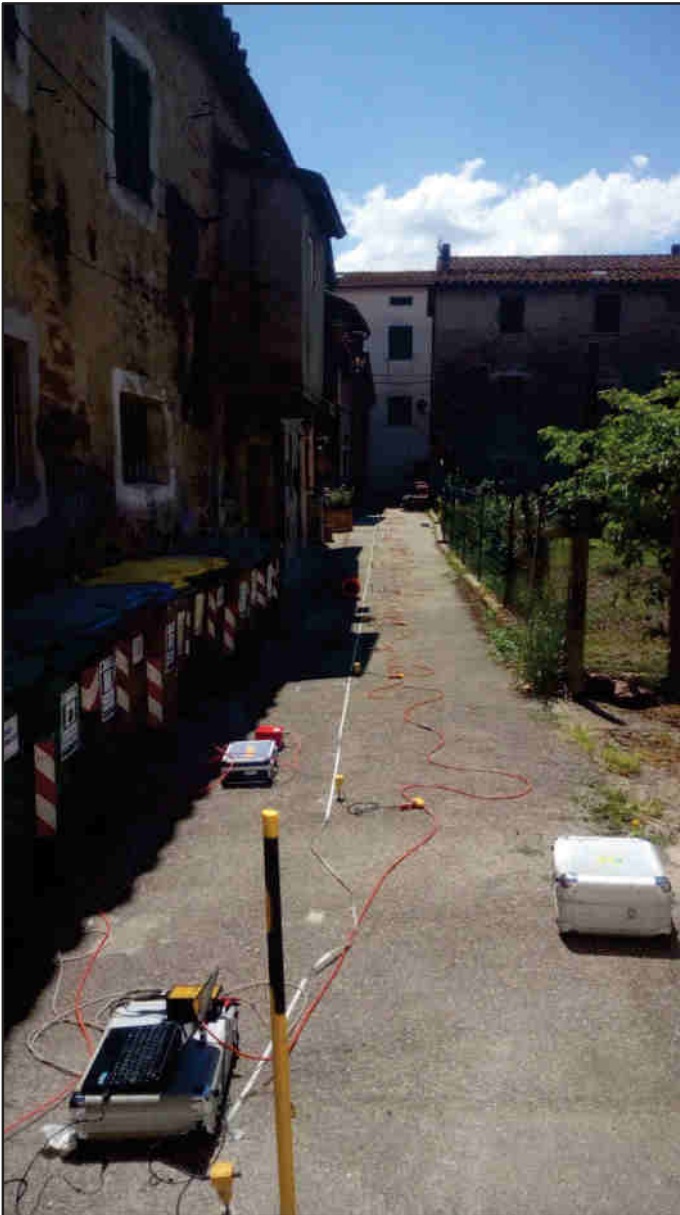
Foto 2: Array sismico – onde di Rayleigh, geofoni verticali 4.5 HZ
