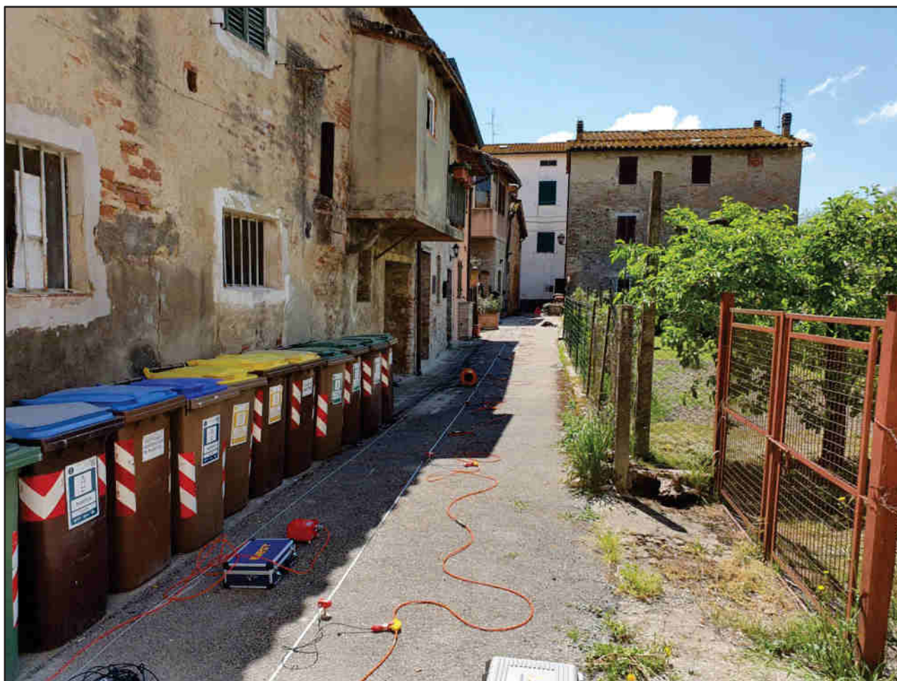
Foto 1: Array sismico – onde di Love, geofoni orizzontali 10 HZ
